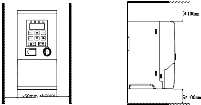
图 3-1 变频器安装示意
